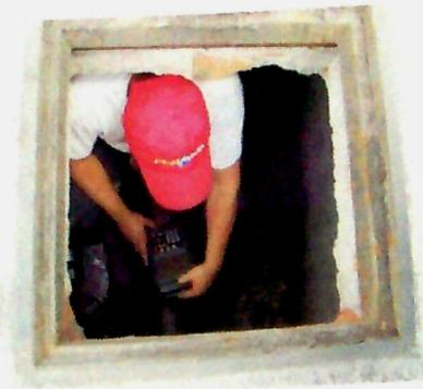
Utilización de medidor ultrasónico portátil en detección de fugas.
